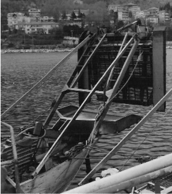
Şekil 2. İtalyan tipi kum midyesi avlama teknesinde direç konumu (A), ülkemiz sularında kullanılan kum midyesi avlama teknesinde direç konumu (B)
